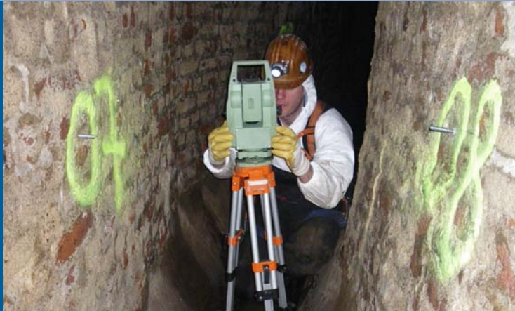
Tachymetrierung im Vorfeld des 3D-Laserscans
